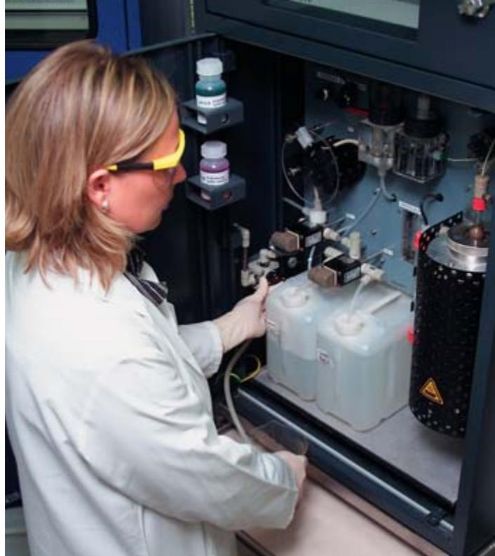
*Vollautomatische Analysegeräte überwachen kontinuierlich die Abwasserqualität.*
